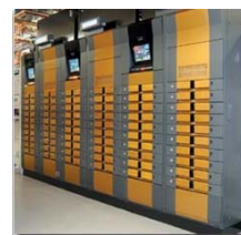
10kwデジタル送信機 (地上デジタル放送向け)
