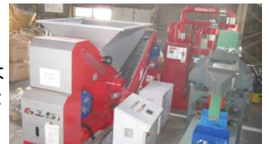
廃電線処理(銅回収)装置の外観
