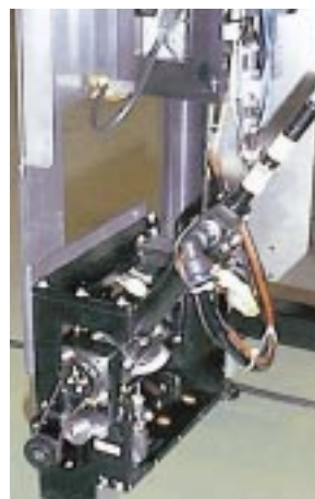
(b) レーザーピーニング施工装置 (内側溶接線用)
