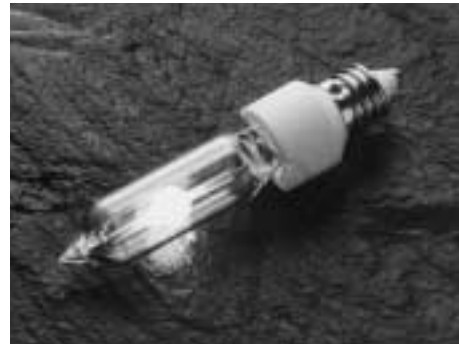
図1 . 20 W 小形セラミック メタルハライドランプ 100 W ハロゲン電球同等サイズの超小形セラミックメタルハライドランプ。直径 6 mm のアルミナ発光管を採用している。 20 W Compact ceramic metal halide lamp
