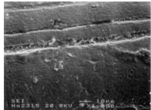
図6 . タングステン線引時に生ずるダイス跡 ダイス跡に, 比較的多量のカーボンが残留している。 Drawing marks on tungsten electrode surface
