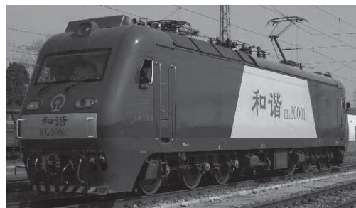
図7. 中国鉄道部向け機関車 — 定格出力7,200 kWのHXD3型式の機関車で、架線電圧はAC25 kV 50 Hz、最高速度は120 km/hである。
