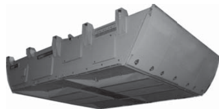
図3. 走行風冷却方式の主変換装置 — 低損失装置の開発と床下走行風の解明により、新幹線では初めて走行風冷却方式の主変換装置がN700系で実用化された。
