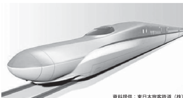
図7. E5系高速新幹線電車の完成予想図 — 架線電圧はAC25 kV (50 Hz)で、1編成は8M2Tで構成されており、最高速度は320 km/hである。
