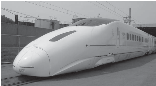
図6. 800系新幹線電車 — 九州路線の35%の急こう配を考慮し、1編成がすべてM車の6Mで構成されている。
