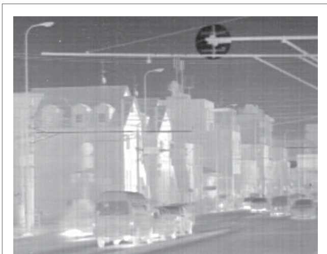
図6. 屋外での撮像例 — NETDが0.25 Kのセンサを用いて屋外を撮影しており、車両のタイヤ付近など、高温の物体が白く映っている。
