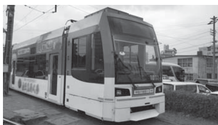
図8. 1000形路面電車 — 1000形路面電車に蓄電システムを搭載し、架線からの給電がなくても10.1 kmを自力で走行できることを確認した。 Type 1000 tramcar
