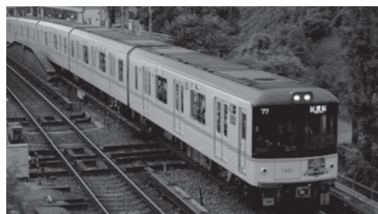
図5. 東京地下鉄(株)1000系車両 — 蓄電システムを搭載し、非常時に最寄り駅まで自力走行ができる。
