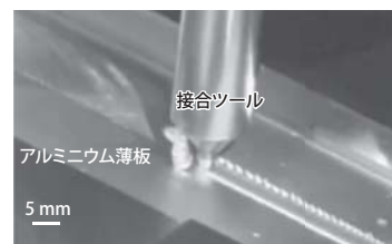
図2. マイクロ摩擦攪拌接合の様子 接合ツールの回転による摩擦熱で薄板を溶融して接合する。 Joining of thin aluminum plates by micro friction stir welding
