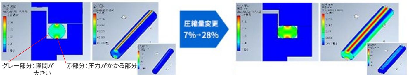
**改善前** 圧力が十分でないためパッキン部品が十分に変形せず、圧縮量が小さい
