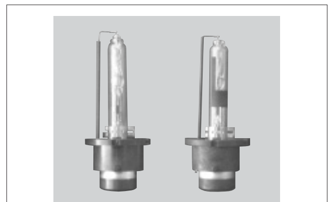
図2. 水銀フリーランプの外観 - 左がD4S(プロジェクター灯具用)、右がD4R(リフレクター灯具用)である。D4Rには外管に配光を制御するため遮光膜が塗付されている。
