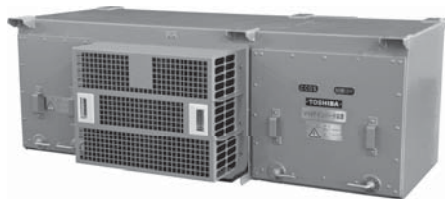
図8. 4in1インバータ装置 — 1台の制御ユニットで4台のPMSMを制御することを可能にして、従来のPMSM用インバータ装置に比べて60%の小型化と50%の軽量化を達成した。 4-in-1 traction inverter
